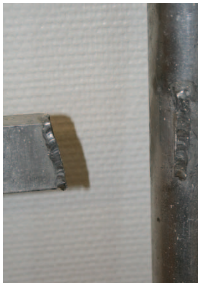
▶ Ett exempel på sammanfogning och svetsning som inte uppfyller Layher standard.
