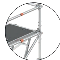
Bild 95: Låsning av spirskarv med skarvrör och skruv och mutter
